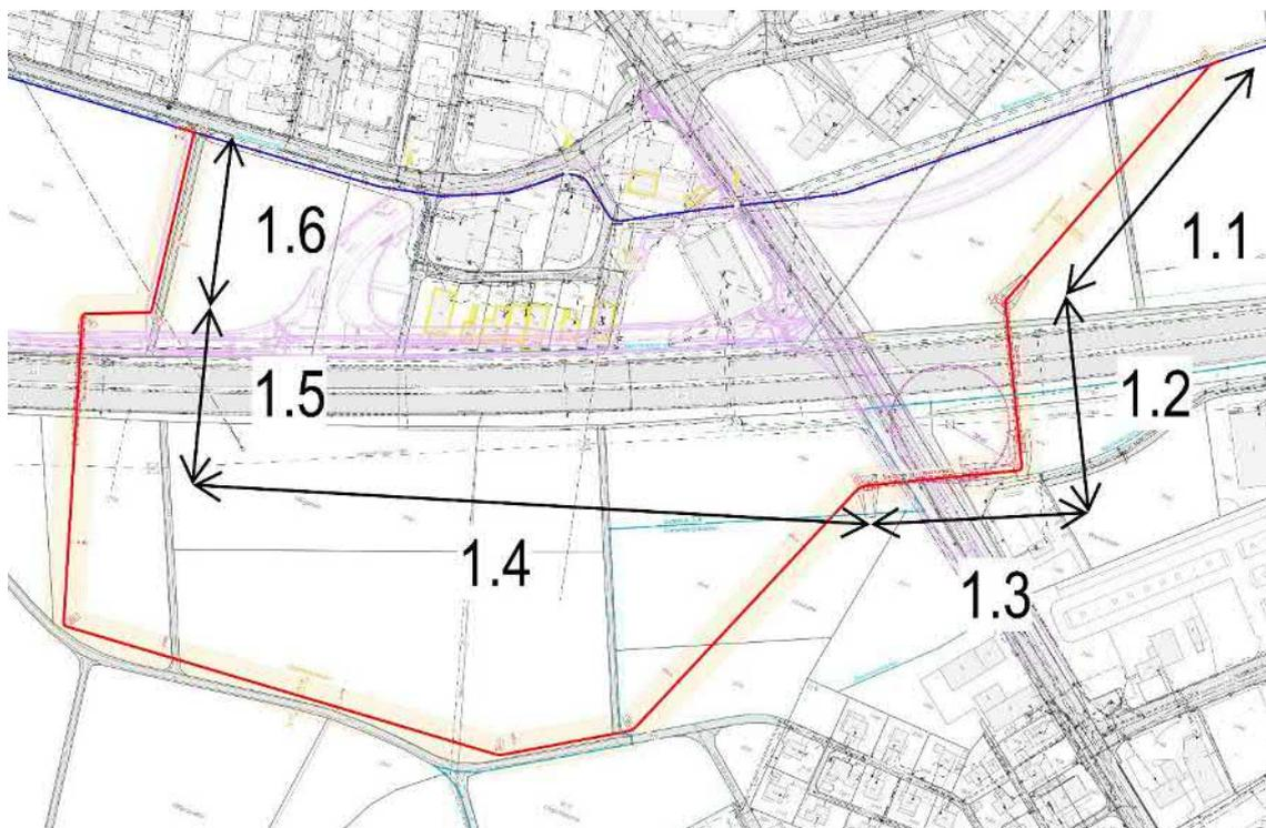
Abbildung 3.3-2: Übersicht Leitungsführung Gashochdruckleitung GVM im Helgefild
