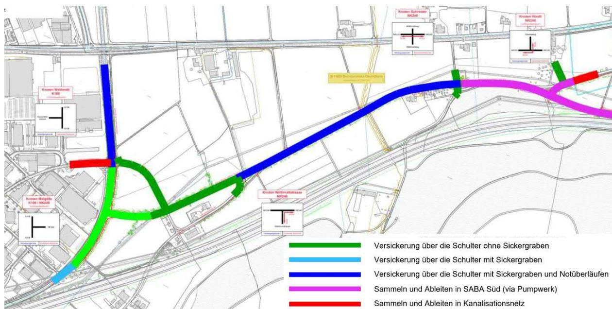
Abbildung 5.2-3: Projektiertes Entwässerungssystem, Los 3 Ausschnitt West [9]
