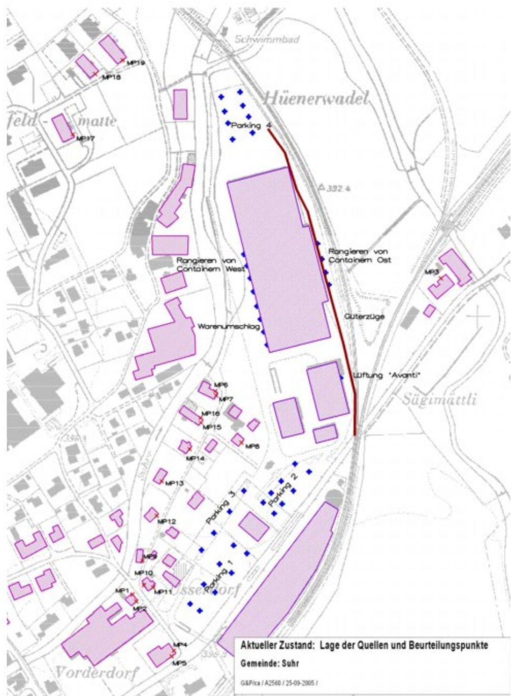
Abbildung 30: Ist-Zustand 2005, Lage der Quellen, Lärmgutachten 2005
