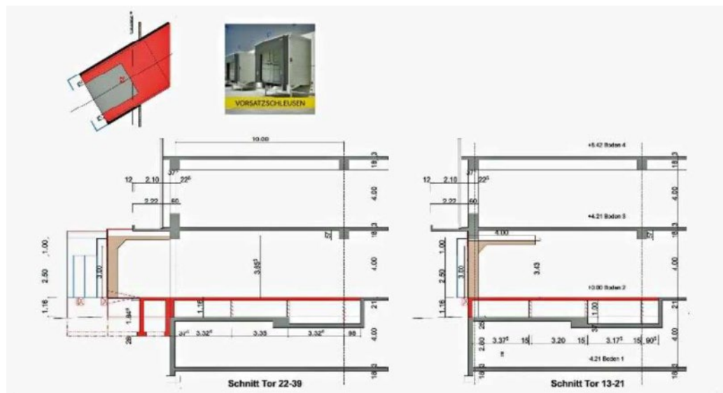
Abbildung 9: Schnitte Neue Anlieferung Warenein- und Ausgang
