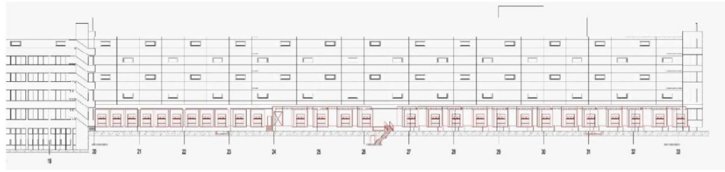
Abbildung 10: Fassade mit neuer Anlieferung Warenein- und Ausgang
