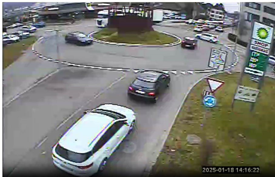
Abbildung 21: Kreisel Alte Gasse / Bernstrasse Ost mit Rückstau von der LSA Bären, der den Kreisel beeinflusst
