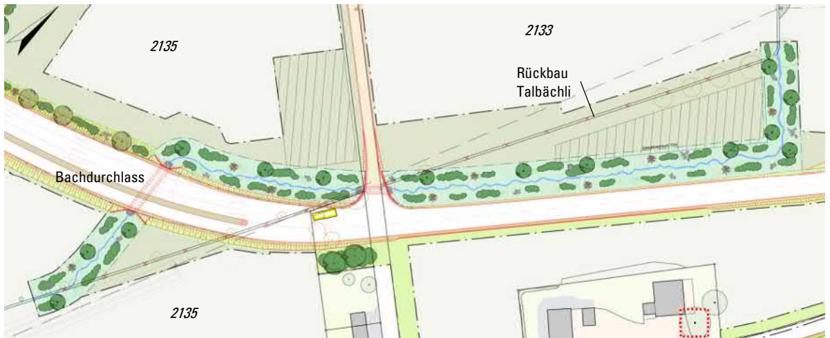
Abb. 5.49 Planausschnitt: Verlegung Talbächli
