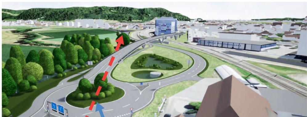
Nach Suhr: Eine Brücke übers SBB-Gleis beim Pfister statt Stau an der Barriere.
